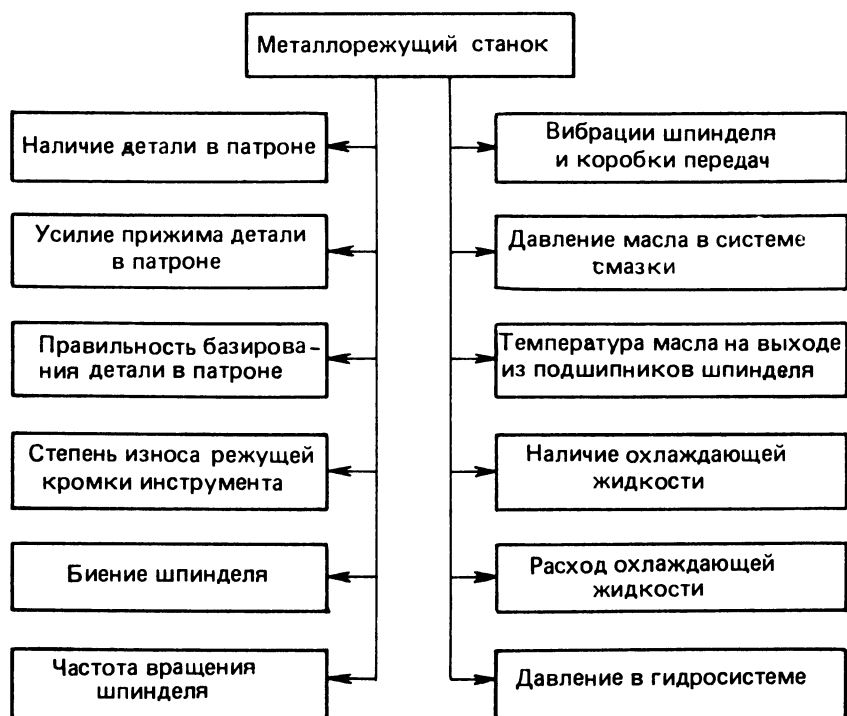
Рис. 13. Параметры, контролируемые информационно-измерительной системой металлорежущего станка
